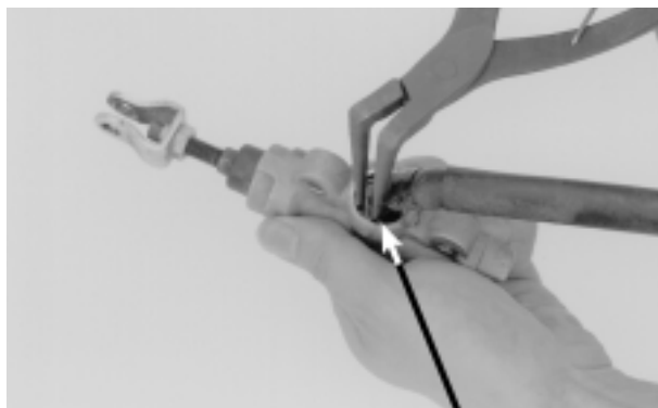
ANEL ELÁSTICO / TUBO DE JUNÇÃO / ANEL DE VEDAÇÃO
